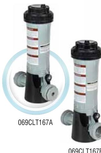
**GEMAŞ CLT-168 KLORİNATÖR.** ABS gövdeli, 4 kg tablet kapasitesi. Cihaz üzerinden dozaj ayar imkanı. Maksimum 150 m<sup>3</sup>'e kadar havuzlar için kullanılır. Off-Line Modelde Havuz basma hattına son derece pratik baypaslı montaj imkanı vardır.
