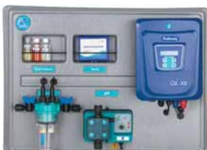
Yukarıdaki özelliklere ek olarak cihaz içerisinde otomatik pH ve Redox kontrolü için gerekli yazılım ve donanım ilave edilmiştir. Cihaz pH ve Redox elektrodlar, akış hücresi ve 2 l/h membranlı dozaj pompası ile birlikte komple bir pano üzerine montajlıdır.
