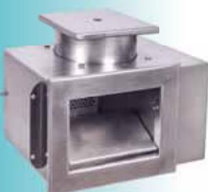
Beton Havuz İçin Paslanmaz Çelik Skimer Gövdeli - Model 2. AISI 304 kalite Paslanmaz Çelikten mamul skimer gövdesi. Emiş ağızı genişliği 190 mm, montaj derinliği 240 mm. Emiş Ø 63 mm PVC, taşma Ø 50 mm. Gövde topraklama bağlantısı mevcuttur. Sürgülü skimer sepeti 04111SS01 ve seviye ayarlı kapağı 04111SS02 ile komple kullanılmalıdır, ürünler aşağıda ayrıca fiyatlandırılmıştır.
