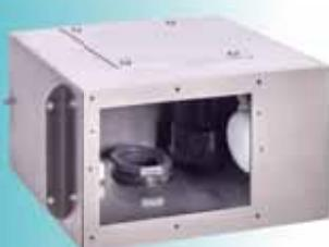
Paslanmaz Çelik Skimer Gövdeli - Model 1. AISI 304 kalite Paslanmaz Çelikten mamul skimer gövdesi. Emiş ağızı genişliği 190 mm, montaj derinliği 240 mm. Emiş Ø 63 mm PVC, taşma Ø 50 mm. Otomatik su seviye kontrolu için şamandıra seçeneği. Gövde topraklama bağlantısı mevcuttur. Sürgülü skimer sepeti 04111SS01 ve seviye ayarlı kapağı 04111SS02 ile komple kullanılmalıdır, ürünler aşağıda ayrıca fiyatlandırılmıştır.
