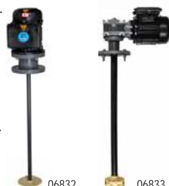
**Motorlu Yavaş Karıştırıcı.** PVC Plastikten mamuludur. 70 d/d hızında yavaş karıştırıcı. 0,13 Kw / 220 V / 50 Hz. şaft uzunluğu: 600 mm. Gaz sızdırmaz PVC montaj flanşları. Fan çapı: 120 mm.
