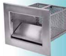
**Beton Havuzlar için Paslanmaz Çelik Seviye Ayarlı Skimer Kapağı.** AISI 304 kalite Paslanmaz Çelikten mamul Seviye Ayarlı Skimer Kapağı. Kapak: 180 x 180 mm. h= 60 - 110 mm arası ayar yapılabilir.
