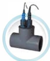
Hat üstü Sensör (Elektrot) Hücresi, PVC'den yapılmıştır. Ø 63 T ile kolay bağlantı Ø 63 PVC Boru. Ayrıca Ø50 mm boru montajı için Ø63-Ø50 mm redüktör içerir.
