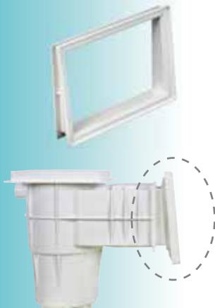
**Skimer Açılı Yatay Uzatma.** ABS plastikten mamul. Her tip mevcut GEMAŞ Skimer ile uyumludur. Her modül (modüller birbirine eklenebilir) orta eksende 30 mm uzatma ve 5° eğik havuz yüzeyi adaptasyonu sağlar. Polyester ve Şevli Havuzlar için tasarılmıştır.
