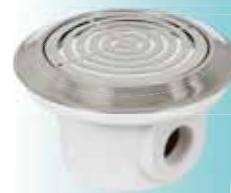
**Kare Dip Süzgeci.** Beyaz ABS plastikten mamul. Altan hidrostatik vana bağlantısı için Ø 50 mm içten yapıştırmalı hazır kör ağız. Flanş, paslanmaz çelik vida ve contalar ile komple. Yandan çıkışlı.
