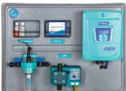
Yukarıdaki özelliklere ek olarak cihaz içerisinde otomatik pH kontrolü için gerekli yazılım ve donanım ilave edilmiştir. Cihaz pH elektrodu, elektrod akış hücresi ve 2 l/h membranlı dozaj pompası ile birlikte komple bir pano üzerine montajlıdır.
