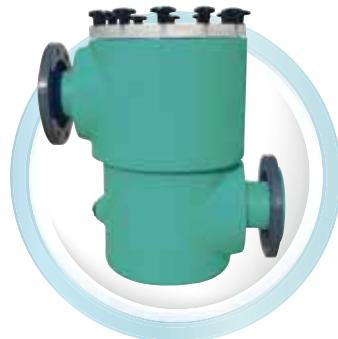
Cam Takviyeli Polyesterden mamul, pompa ön filtresi. Kayar flanşlı bağlantı ağızları. Ø280 - Ø315 ve Ø355 mm çaptakiler 125 l; Ø400 ve Ø 450 mm çaptakiler 285 l kapasitelidir. Sepeti AISI 304 paslanmaz çeliktir. Şeffaf akrilik kapaklıdır. Ø225 mm'ye kadar bağlantılar için kullanılabilir.
