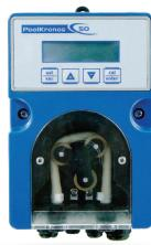
**PoolKronos** tekli peristaltik dozaj sistemleri kademeli motorlu pompayla, 3 PVDF silindire sahiptir ve pH/ORP ölçümü için entegre kontrolörleri kullanmaktadır.
