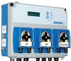
**Kommveer** gelişmiş bileşik sistem kimyasal parametreleri ayıran ya otomatik oransal ya da zamanlamalı dozajlı iki ya da üç peristaltik pompayı sahiptir ve devridaim pompasının haftalık zamanlı yönetimini mümkün kıلان entegre işlevler ve bir röle aracılığıyla kazana yönelik bir sıcaklık sensörü sunmaktadır.
